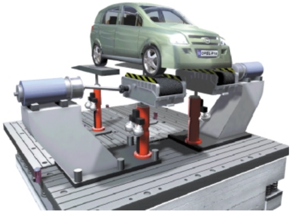
Übersichtsdarstellung des Deterioration-Prüfstands mit den vorderen Flachbahnen und den hinteren Radtellern
