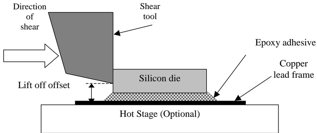
**Figure 6. - Die Shear Test**
