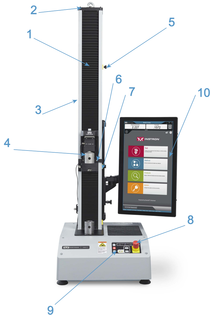
Abbildung 1. 3400 Einsäulenprüfrahmen als Tischmodell mit Bluehill® Bedienerdashboard - Frontansicht
