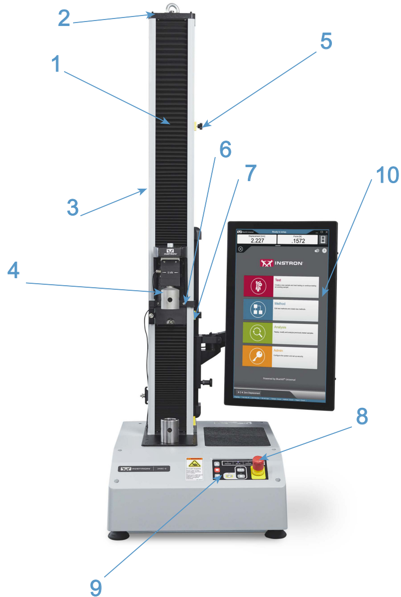
Abbildung 1. 3400 Einsäulenprüfrahmen als Tischmodell mit Bluehill® Bedienerdashboard - Frontansicht
