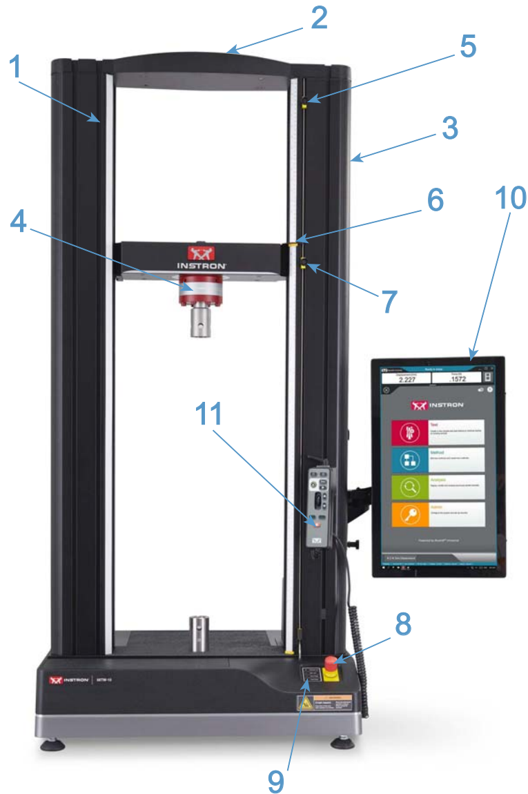
Abbildung 1. 6800 Zweisäulen-Prüfrahmen als Tischmodell mit Bluehill® Bedienerdashboard - Frontansicht
