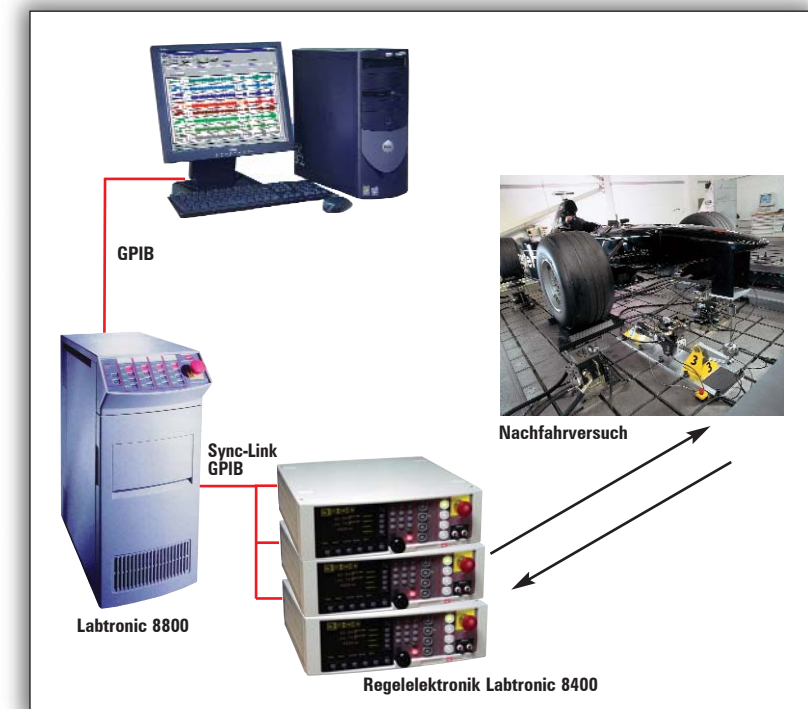
▲ Konfiguration einer mehraxialen Prüfung in Verbindung mit einer Labtronic 8800
