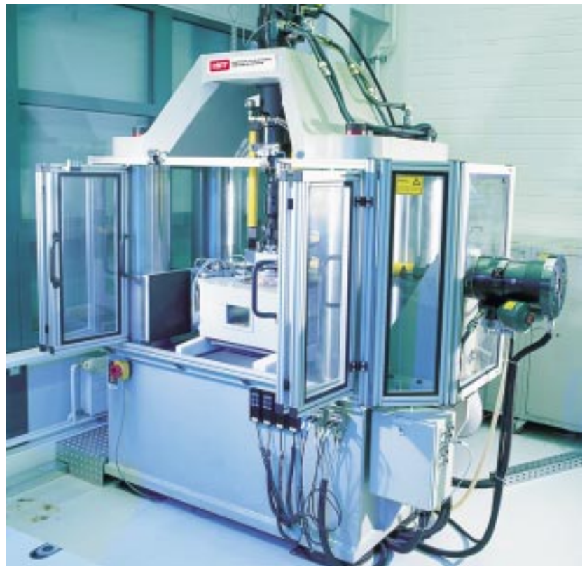
▲ 4-axiales Prüfsystem zur Prüfung von Bauteileigenschaften und für Dauerfestigkeitsuntersuchungen
