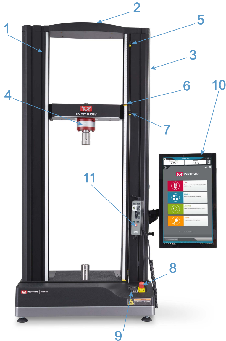
그림 1. Bluehill® 작업자 대시보드가 있는 6800 이중 컬럼 테이블 모드 - 전면
