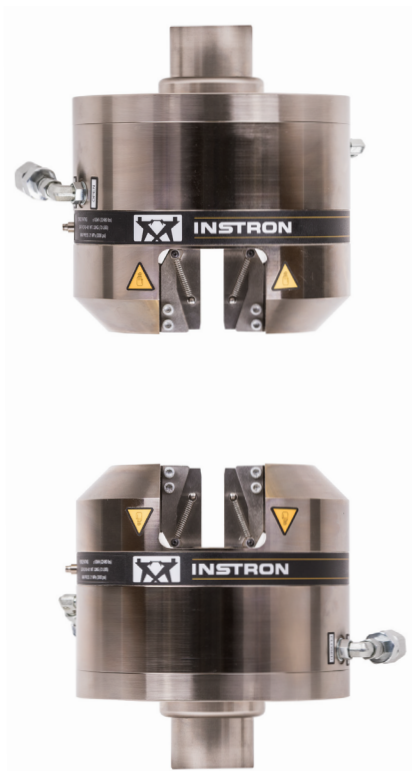
±100 kN 万能油圧式くさび型グリッパ
