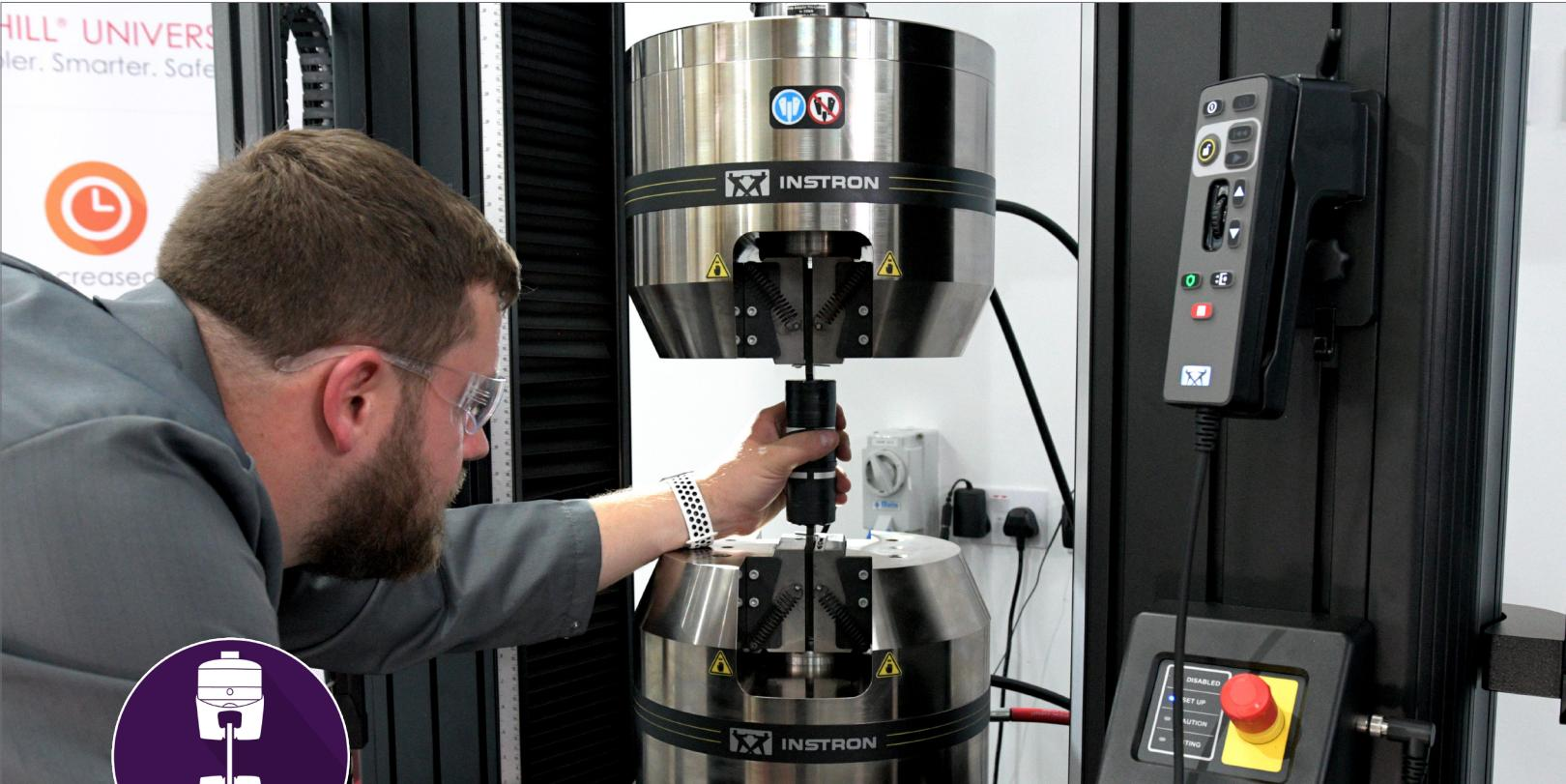
Die Außendienst- und Kalibrierungsingenieure von Instron arbeiten direkt mit ASTM und Nadcap zusammen und erhalten so ein besseres Verständnis der Anforderungen an die Ausrichtung von Materialprüfsystemen. Wir haben Dienstleistungen für die Ausrichtung entwickelt und eingeführt, die die Richtlinien und Berechnungen gemäß ASTM E1012 sowie Nadcap-Normen einhalten.
