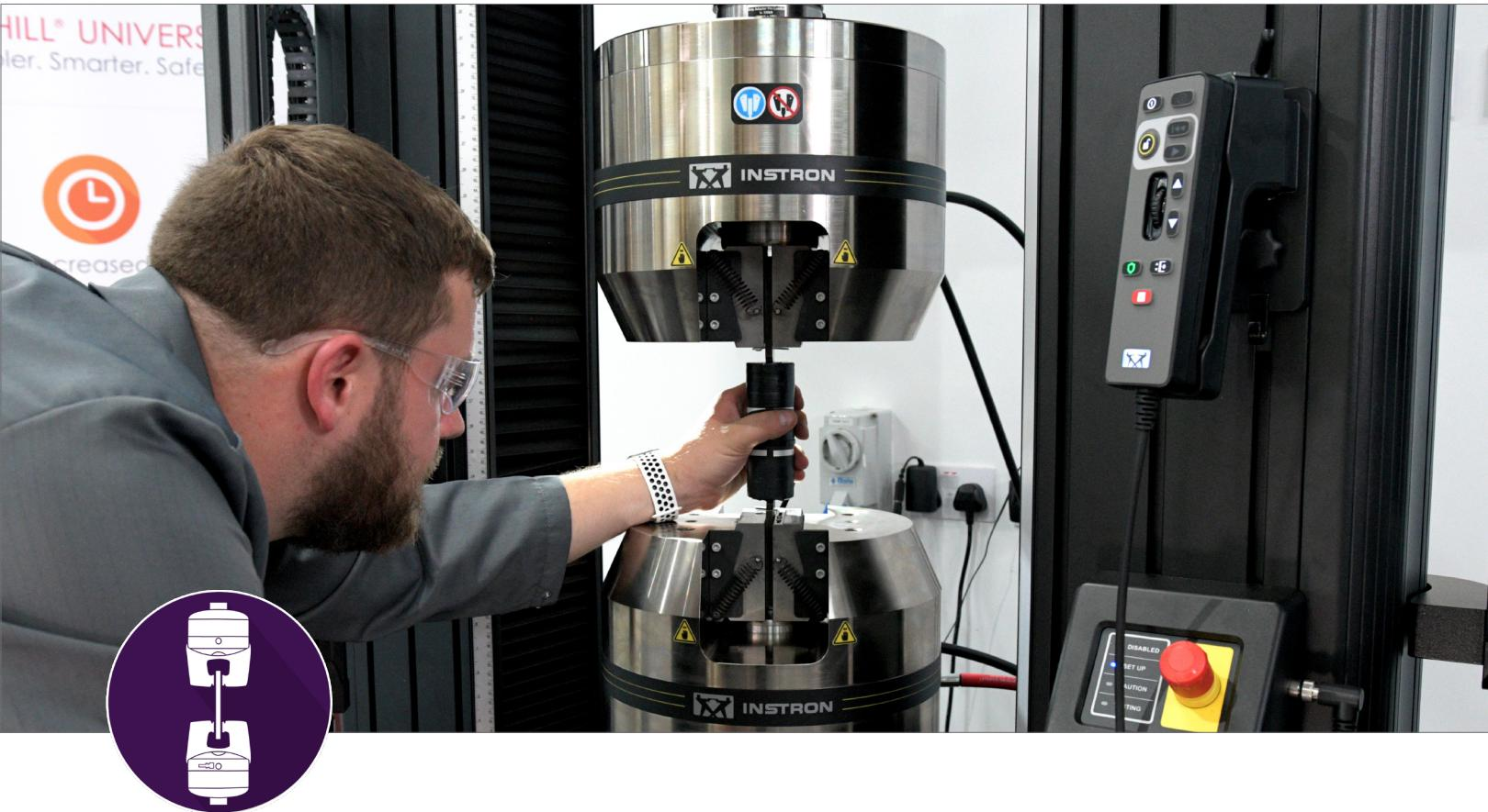
Les ingénieurs du service sur site et de l'étalonnage d'Instron travaillent directement avec les organismes de normalisation ASTM et Nadcap pour comprendre les exigences d'alignement des systèmes d'essais des matériaux. Nous avons développé et établi des prestations de contrôle d'alignement conformes aux directives et aux calculs détaillés dans les normes ASTM E1012 et Nadcap.
