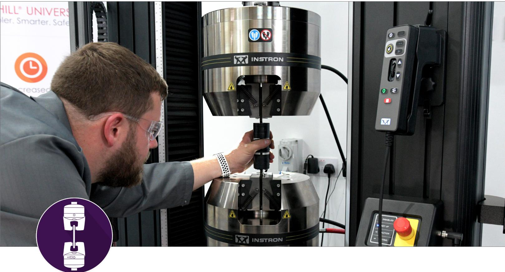
Los ingenieros de servicio TÉCNICO y calibración de Instron trabajan directamente con ASTM y Nadcap para comprender los requisitos de alineación de los sistemas de ensayo de materiales. Hemos desarrollado y establecido servicios de calibración de alineamiento que cumplen las directrices y cálculos detallados en las normas ASTM E1012 y Nadcap.
