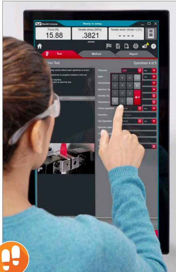
Bluehill Universal 소프트웨어가 전체 실험 순서를 시험자에게 단계별로 안내해주므로, 시험의 반복성과 단순성이 보장되며 시험 오류를 방지할 수 있습니다. 프롬프트는 운영자가 지정한 텍스트와 이미지를 이용하여 사용자 정의 구성이 가능합니다.
