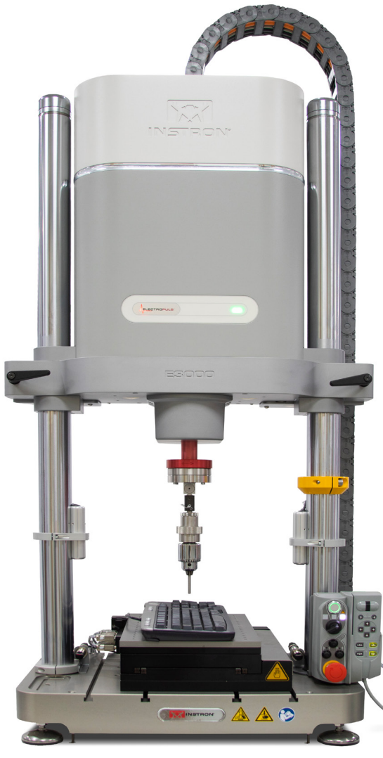
자동 XY 스테이지와 WaveMatrix2 소프트웨어를 사용한 ElectroPuls E3000 설정
