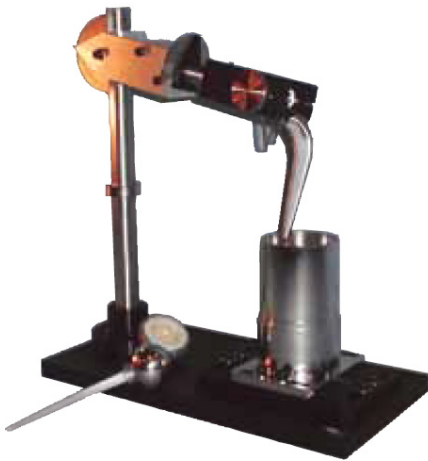
包埋装置可确保试验中植入物的正确定位
