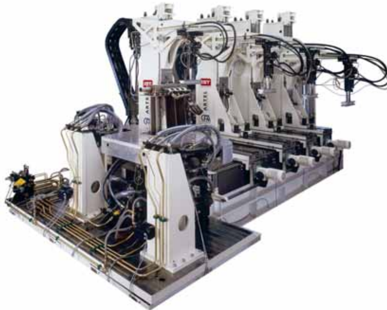
Bild 1. Beispiel für ein Betriebsfestigkeits-Prüfsystem von IST für Abgasanlagen
